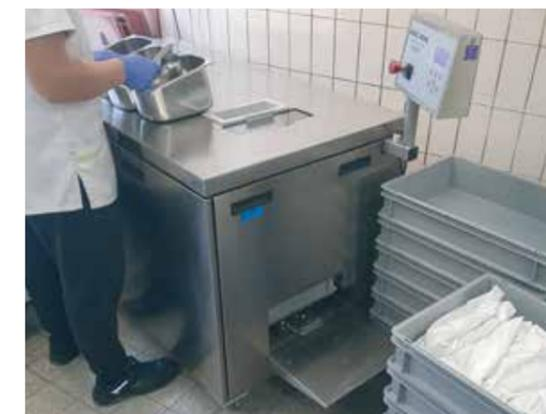
Die neue Besteckeinwickelmaschine vermeidet zusätzlichen Verpackungsmüll für die Corona-Hygienemaßnahmen.
