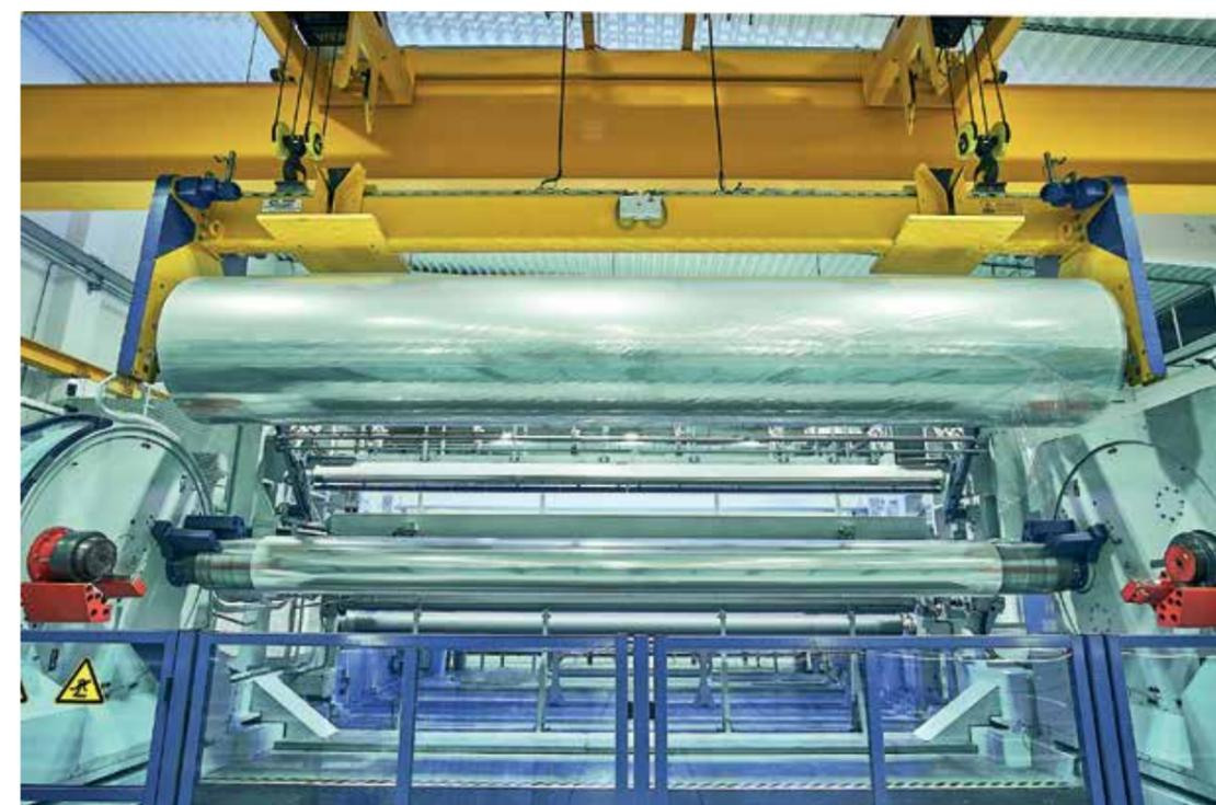
Hochmoderne Extruderanlage zur Herstellung von bedruckbaren PET-Folien für die Lebensmittelverpackungsindustrie
