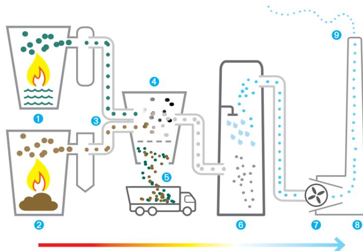
Schema Rauchgasreinigung Abfallverbrennung: 1. Flüssigrückstandsverbrennung, 2. Klärschlammverbrennung, 3. Rauchgase, 4. Gewebefilter, 5. Filterstaub, 6. Rauchgaswäscher, 7. Saugzug, 8. Kamin, 9. Reingas
